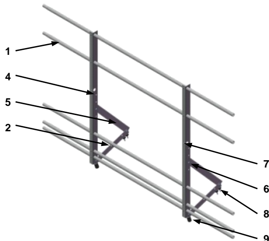
Ограждение кровли Optima 1,2 м со снегозадержателем
